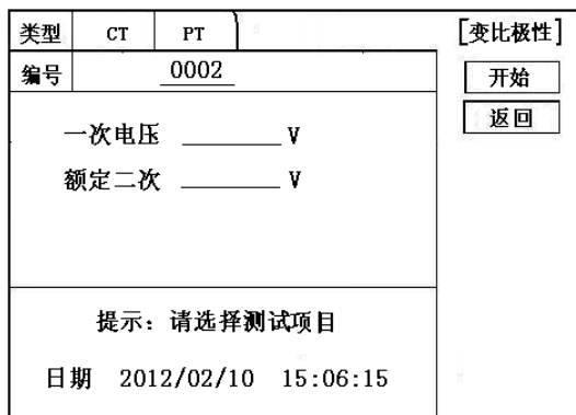
图 19 PT 变比极性测试界面
