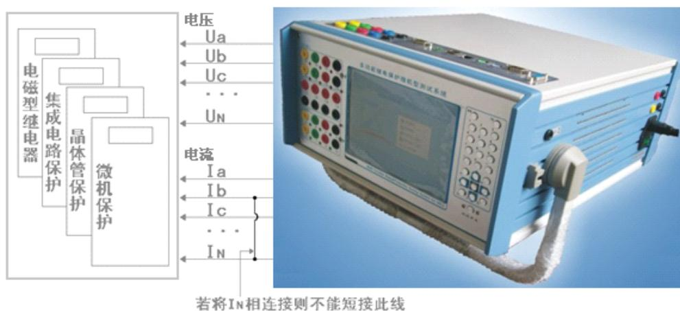
图 3.1.2 相间输出端子连接方式
